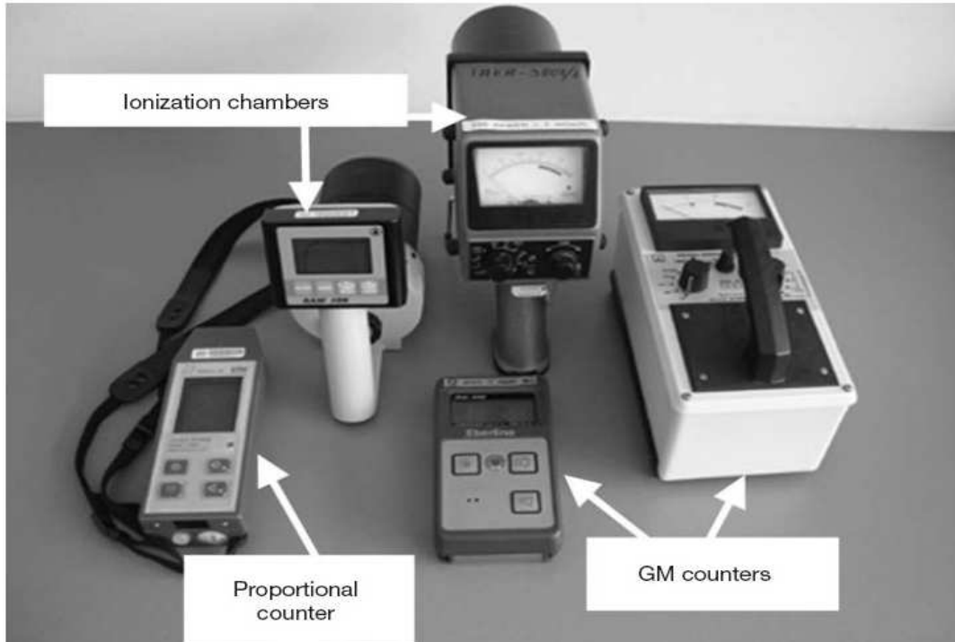
۱۲۷- شکل: دهستوي وړانګولکه الفا ، بېتا او ګاما وړانګو داندازه کولو او د هغوی د انرژي د ټاکلو په موخه ځیني تخنیکي موبایل آلی بنودل شوي دي IAEA (6) .
